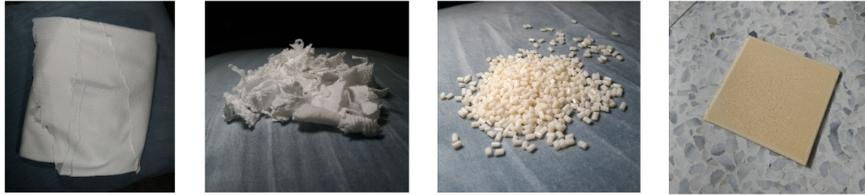
圖13 布料、切碎的布料、0.3mm聚酯粒、熱壓成片
